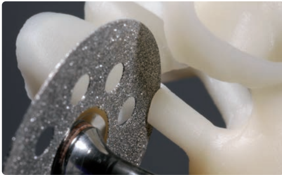
細粒子ダイヤモンドディスクを使用してスプルーを切断する。
