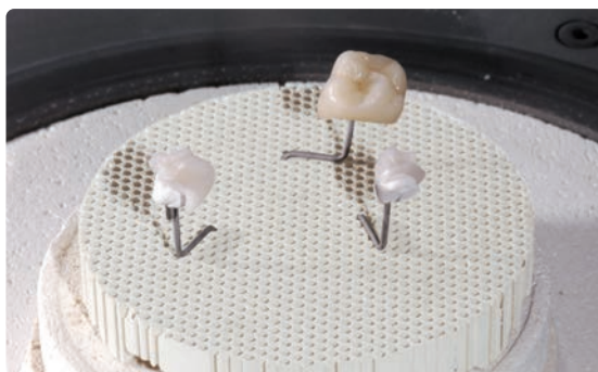
焼成トレイおよび焼成ピンを使用して、規定のパラメータに従ってステインおよびキャラクタライゼーション焼成をする。
