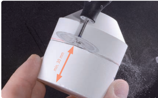
カuttingディスクを使用して、基底面から最低30mmの長さで埋没リングを分割する。
