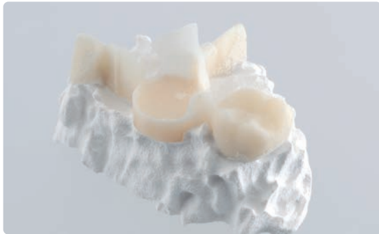
精密な掘り出しは、2 気圧のガラスピースで行う。
