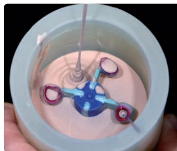
埋没材が IPS シリコンリング内を徐々に満たすように、埋没材をゆっくりと流し込む。
