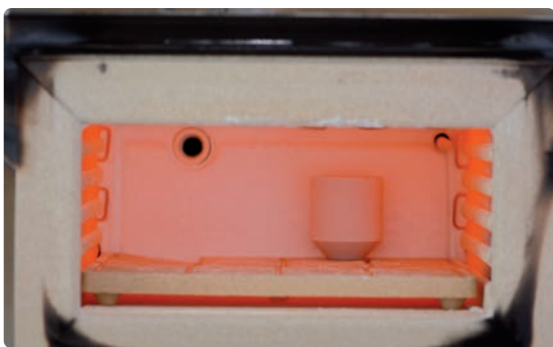
埋没リングは奥の壁に近い位置に、開口部を下に向けて置く。
