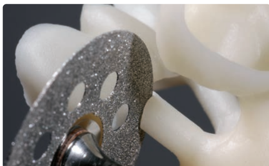
細粒子ダイヤモンドディスクを使用してスプルーを切断する。
