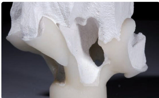
精密な掘り出しは、2 気圧のガラスピーズで行う。
