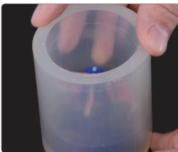
IPS シリコンリングは、IPS Multi インベストメントリング ベースに隙間がないように装着する。
