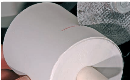
カuttingディスクを使用して埋没リングを分割する。
