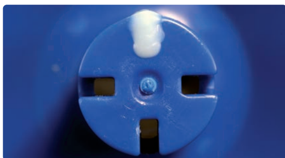
スプルーイングしない IPS Multi インベストメントリング ベースの開口部は、多めのワックスで封鎖する。
