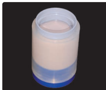
埋没材を IPS シリコンリング内側の印まで流し込み、リングゲージを片方から徐々におろして装着する。
