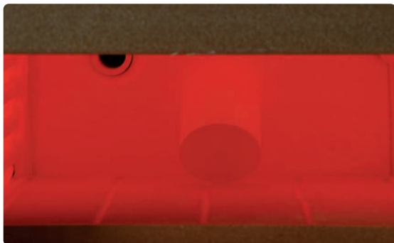
埋没リングは奥の壁に近い位置に、開口部を下に向けて傾ける。リングファーネスの温度センサーから離れた位置に置く。
