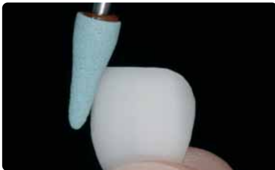
Zu starker Anpressdruck und Überhitzung beim Cut-Back sind zu vermeiden.
