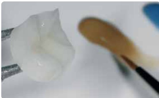
Замешанные красители Shade нанести прямо на необожженный слой глазури. На пришеечной и окклюзионной поверхностях цвет дентина сделать более интенсивным, для имитации режущего края использовать Shade Incisal.
