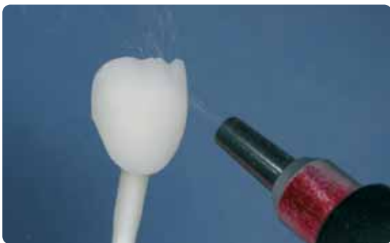
Sabbare il restauro con Al_2O_3 a 0,5 bar (attenzione: abrasivo)
