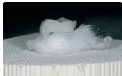
Completare il portaoggetti a nido d'ape con gli oggetti ed avviare il programma di cottura.
