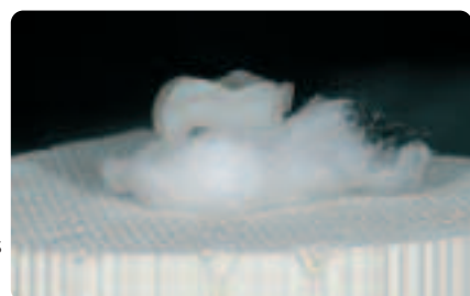
Colocar los objetos sobre la bandeja de cocción de nido de abeja e iniciar el programa de cocción.
