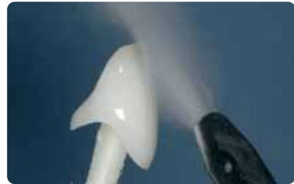
Vor dem Bemalen die Restauration mit dem Dampfstrahler reinigen.
