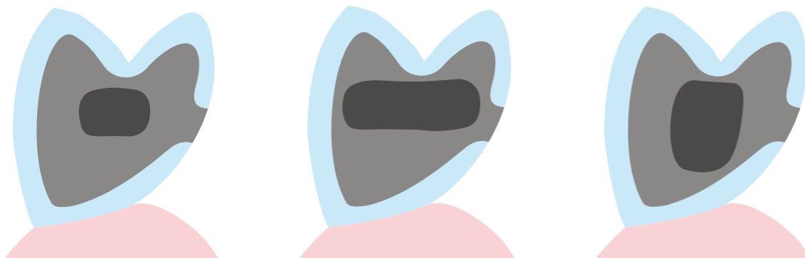
Einfache Breite des Verbinders = einfache Stabilität
