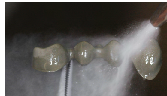
Nach dem Abstrahlen das Metallgerüst mit dem Dampfstrahler reinigen und gründlich trocknen lassen. Den Oxidbrand nach Herstellerangaben durchführen
