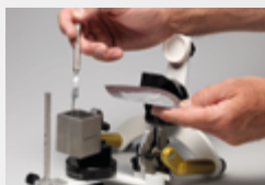
UK-Halter im Stratos-Unterteil mit Adesso Split-Magnetplattensystem befestigen, Justierkleber im Kalibrierobjekt einbringen
