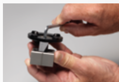
Artikulator-Kalibrierobjekt (Art.-Nr. 680343) am OK-Halter montieren und fixieren
