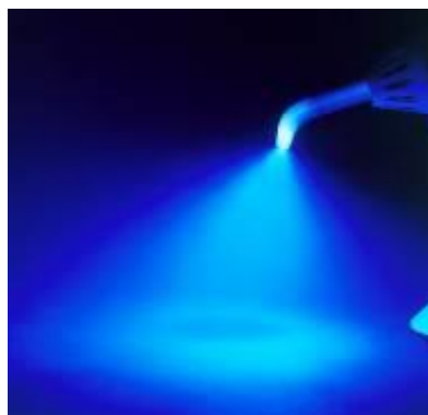
Abb. 8b: Lichtstreuung eines sich stark verjüngenden Lichtleiters (13 > 8 mm)
